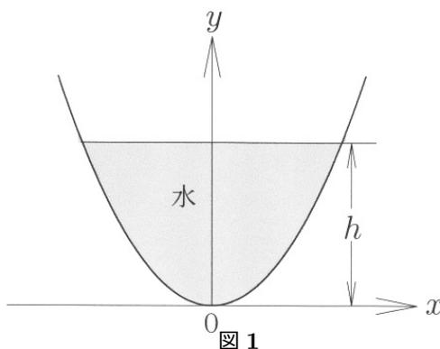
図 1 に示すように, 灌漑用の水路があり, そこに堰 (ダム) が設けられている. この堰の断面は図に示すように, 左右対称な U 字型になっている. この水路に高さ  $h$  まで水が入っているときに堰を全開するとどのように水が流れていくかを考える. ただし, この水路の水平部分は十分に長く, 水面の高さ  $h$  は, 堰を全開しても, すぐには変化しないものとする. 図に示すように, 水平方向に  $x$  軸, 鉛直上方向に  $y$  軸をとる. 堰の断面の形を  $x$  正の側で  $x = f(y)$  とする. 高さ  $y$  の部分で水が飛び出る速度は, Torricelli の原理によると,  $g$  を重力加速度として,  $\sqrt{2g(h-y)}$  で与えられる. したがって, 微小厚さ  $dy$  の部分から水が単位時間に出る量は  $2\sqrt{2g(h-y)}f(y)dy$  となる. 2 が付くのは  $x$  負の側も含めたためである. これを高さ方向  $y$  について合計し
